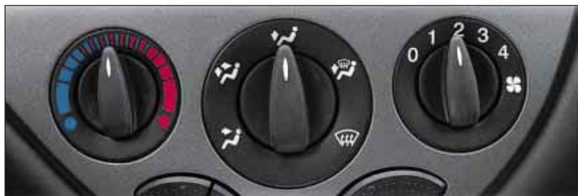
Bild 5: Die Heizungs- und Lüftungsblende des Ford Focus wurde in Folienhinterspritztechnik hergestellt.
